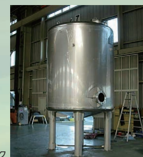
4000ℓ貯蔵タンク
