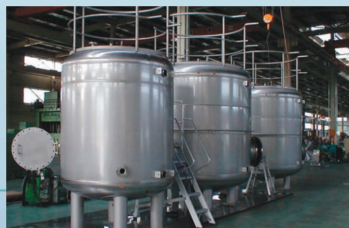
10000ℓ純水タンク
