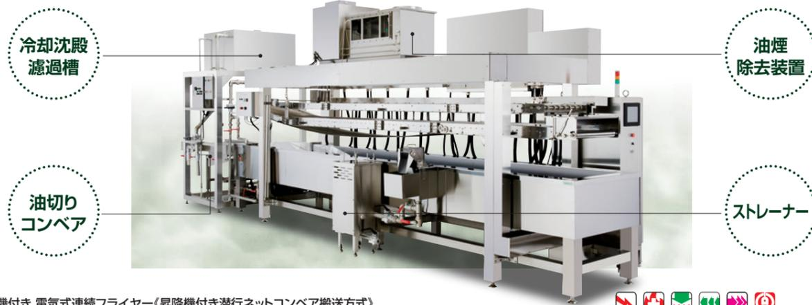
■昇降機付き 電気式連続フライヤー《昇降機付き潜行ネットコンベア搬送方式》
